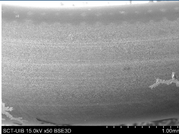
a) Visión general de la superficie del catéter
