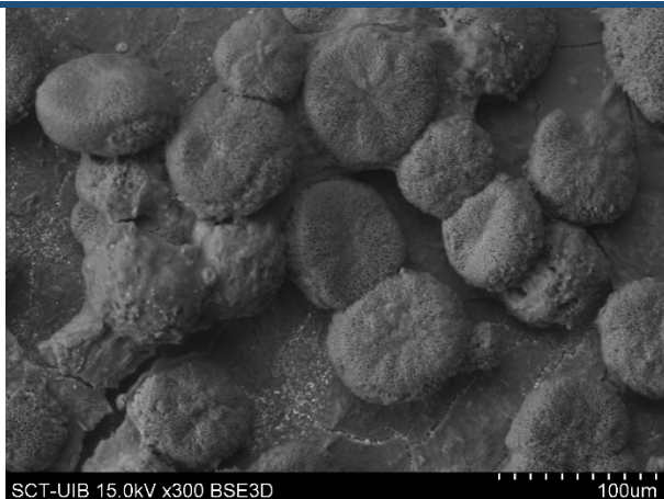
c y d) Detalle de los cristales de urato amónico
