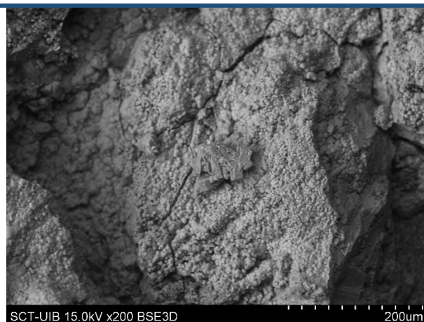
b) Detalle de los cristales de BRU
